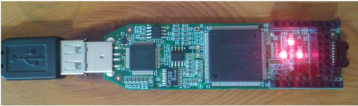
Figure 37: Fotografía de la placa ICESTICK con contaje binario en los LEDs.
